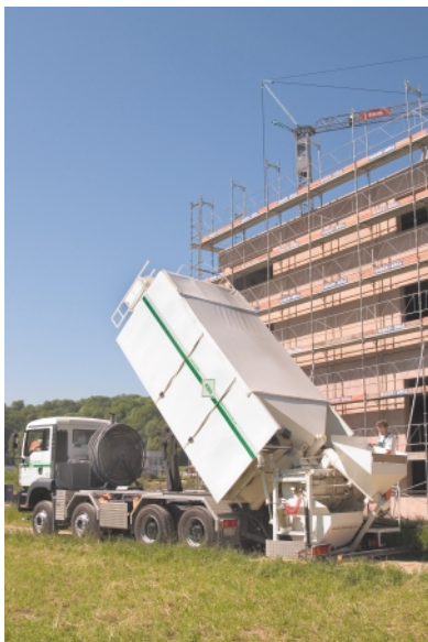
Mix-Mobil mit Misch- und Pumpaggregat für das genaue Dosieren, Mischen und Pumpen des Mörtels
